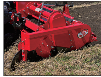
図 佐賀県現地播種 (3月10日) 爪配列を変更し、3畝立て仕様で播種
