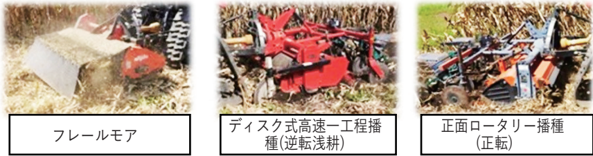
図 収穫直後のディスク式高速一工程播種では、フレールモア不要
