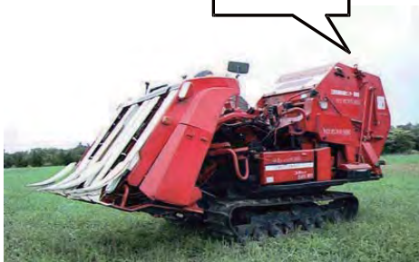
ロールベールアタッチを装着したWCS用収穫機
