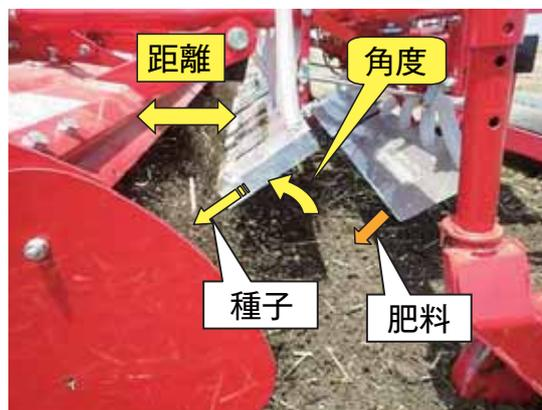
写真2 表層散播・散粒状況と設定
