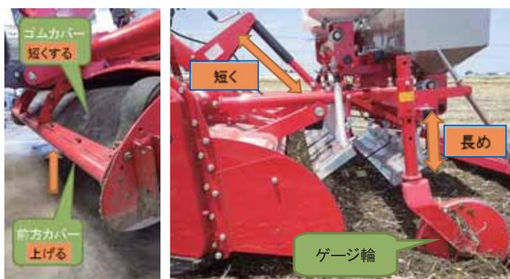
写真1 アップカットロータリ 設定箇所
