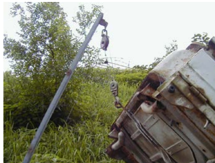
マストと荷台の吊り上げ部
