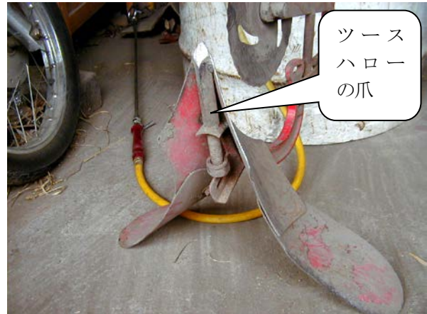
補強した培土板
