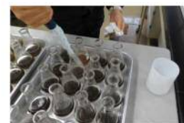
5-2. 室温まで静置冷却させた抽出液は、濁らないようゆっくりと上澄み液を吸い取ります
