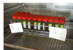
2-4. 乾燥機内で16時間保温します。加温時間は±30分以内を守ります
