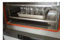
3-6. 80℃設定で16時間加温します。加温時間±30分以内を守ります
