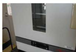
2-3. 使用する乾燥機は通風式でも、通風式でなくてもよい。あらかじめ80℃に設定しておきます
