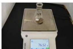
3-1. 土壌を3.0g量り、三角フラスコに入れて、あらかじめ総重量を測定しておきます
