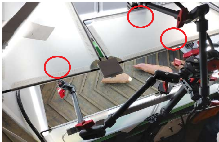
▲ 傷検知 AI を実装したプロトタイプの選別装置。角度の異なる 3 台のカメラ（赤丸で囲んだ位置に存在）を使い、腐敗リスクのある打撲傷を検知する。
