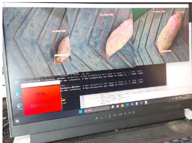
▲ 傷検知 AI を実装したプロトタイプの選別装置。角度の異なる 3 台のカメラ（赤丸で囲んだ位置に存在）を使い、腐敗リスクのある打撲傷を検知する。
