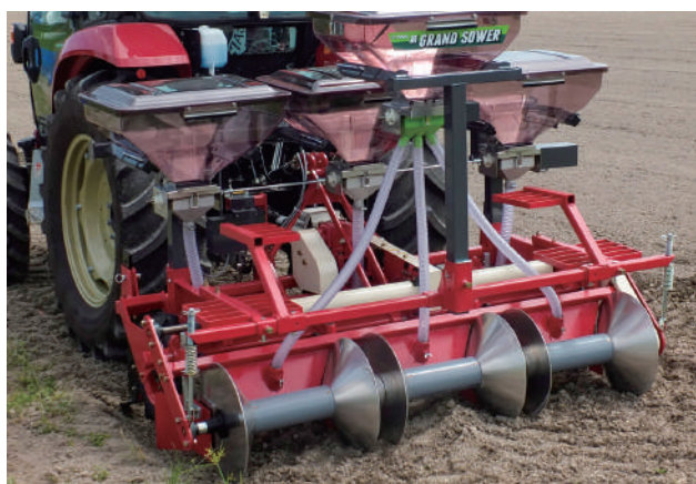
▲ 畝立て同時二段局所施肥機（条間60cm仕様）。 （上田農機（株）、（株）タイショー、農研機構との共同開発）
