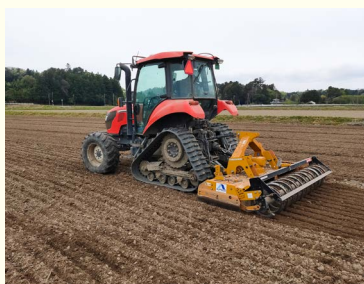
パワーハローによる整地
