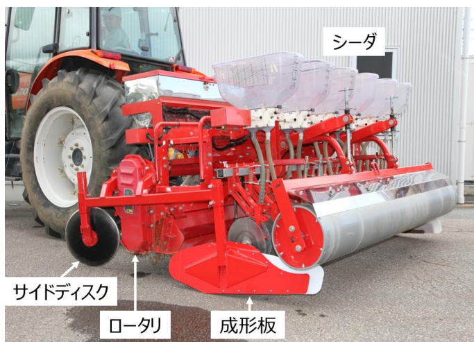
図 I -14 小明渠浅耕播種機の一例
