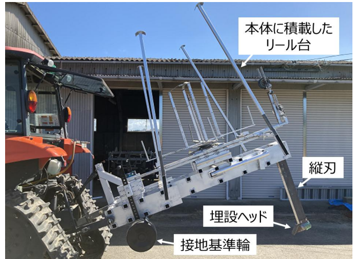
図 I -5 開発した排水管理設置装置
