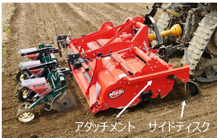
図 I -15 ディスク式高速一工程播種機
