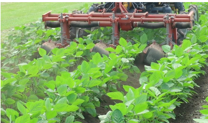
図 I -23 ロータリ式中耕培土機での培土作業
