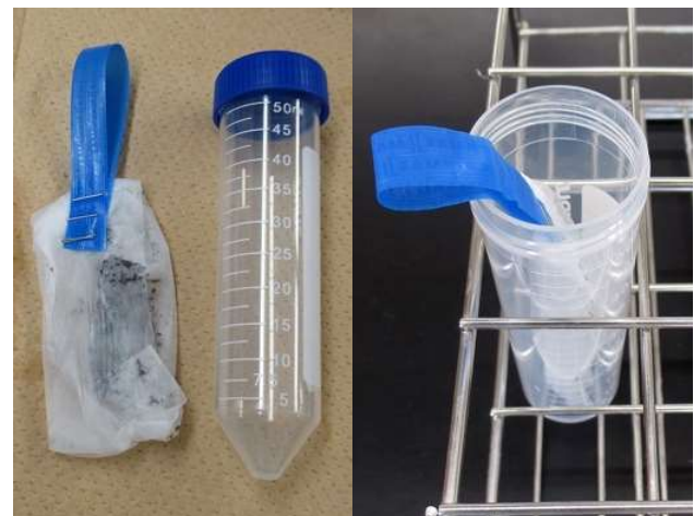
図 4 昆虫をお茶パックで濾し取り、遠沈管にセットする
