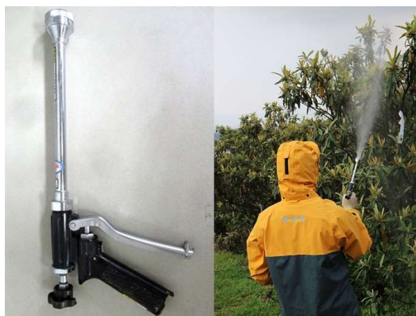
図IV-17 ピストル噴口 AF-5（永田製作所）（左）と散布の様子（右）
