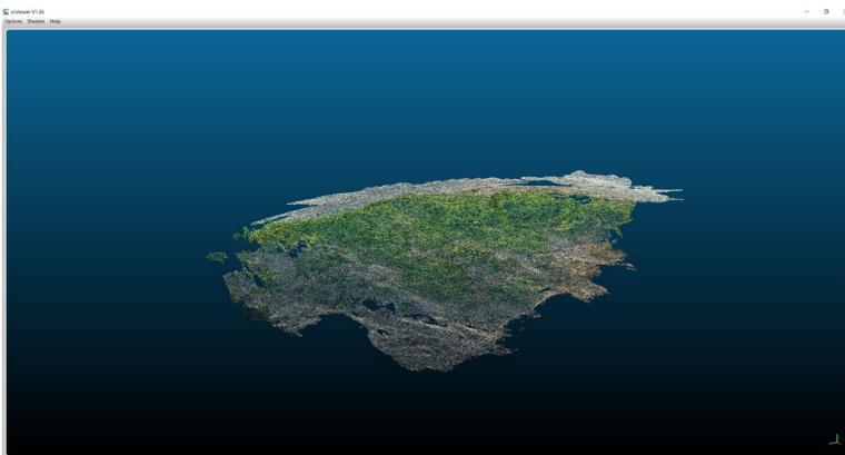
図Ⅱ-12 3次元点群データ（LiDAR 搭載端末を用いて3次元化）
