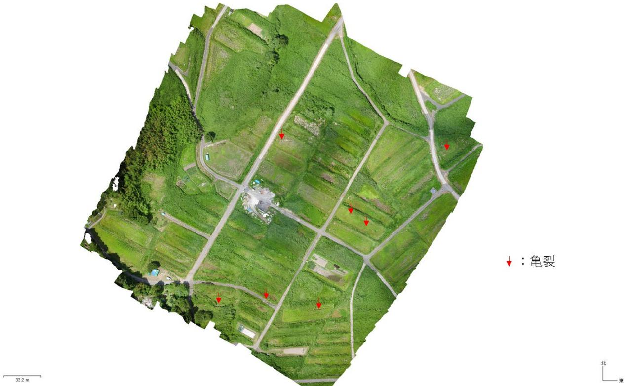
図V-6 ドローン空撮画像による災害発生時の被害状況の把握
