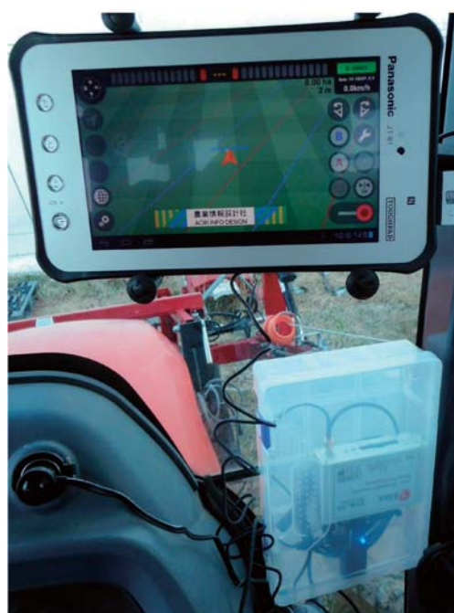
タブレットコンピュータとGNSS受信機を 組み合わせて構成されたガイドンス
