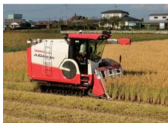
収量コンバイン(ヤンマー社開発機)
