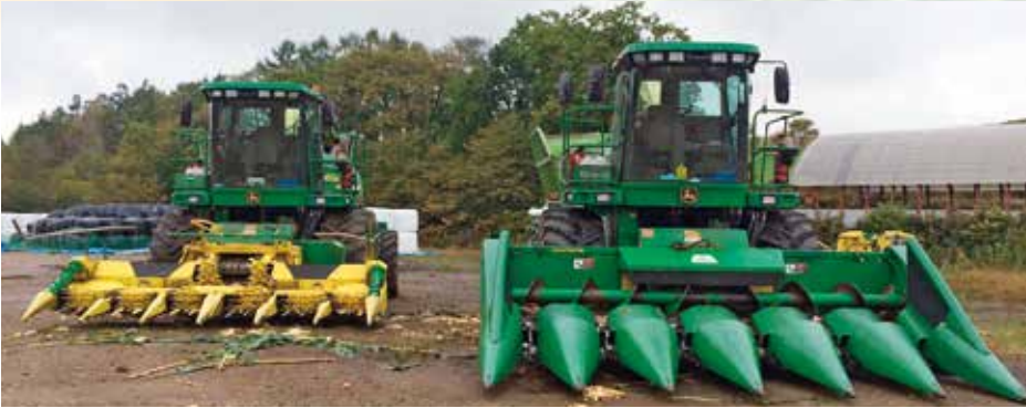
写真6. 左奥はホーククロップ収穫用ロータリーヘッド、右手前はイアコーンサイレージ収穫用スナツパヘッド。
