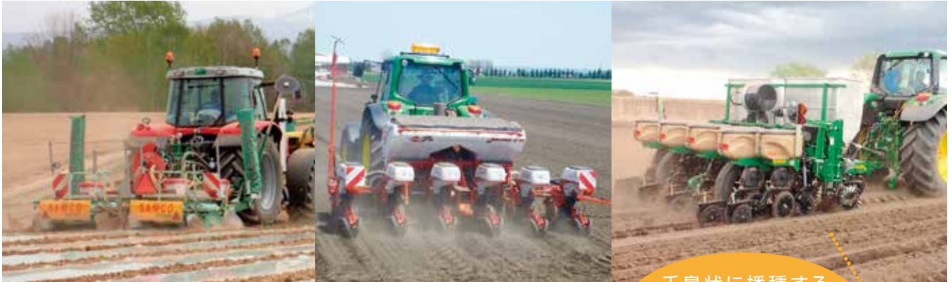
写真2. マルチ播種機(左)、真空播種機(中)、千鳥播種機(右)
