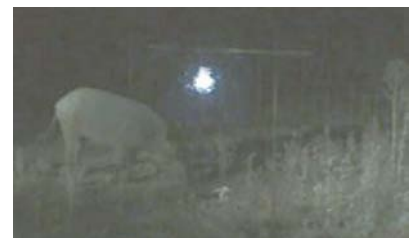
図5. 青LED忌避効果試験 イノシシは2日目に慣れ、光を無視して餌を食べるようになりました
