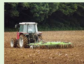
ハローによる砕土・整地作業
