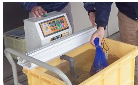
温湯種子消毒機（湯芽工房YS101） 使用時には温度低下防止のため蓋をします
