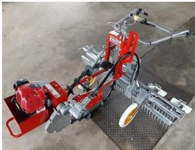
写真は基本構成である4条処理対応の機械。
