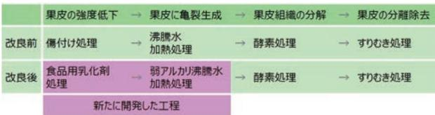
図1 カキ果実の酵素剥皮工程
