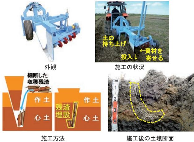
図 有材補助暗渠機カットソイラーの外観と施工方法
