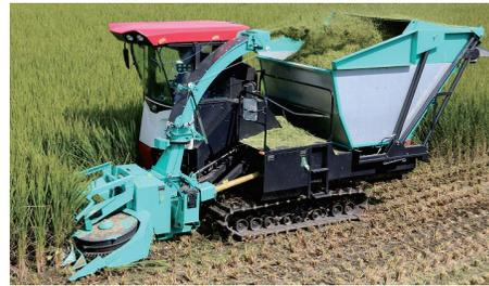
図1 汎用型微細断飼料収穫機（ワゴンタイプ）
