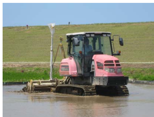
レーザーでの耕深管理による攪拌
