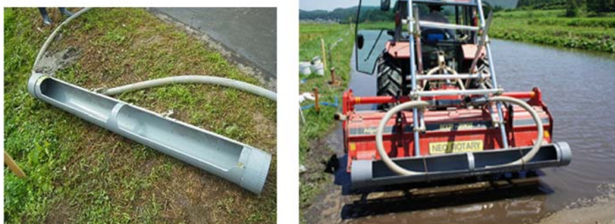
図 II-3.4 現地試験で用いた攪拌・吸引部(塩ビ製樋をパイプサポートで支持)
