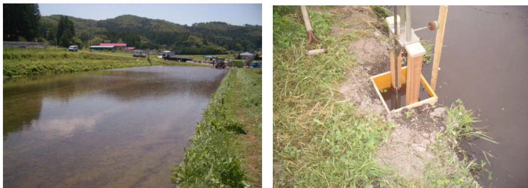
図 II-3.3 ほ場の湛水状況と湛水深の計測(福島県飯舘村現地試験ほ場)
