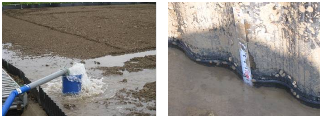
図 I -3.9 ほ場の湛水状況と湛水深の計測
