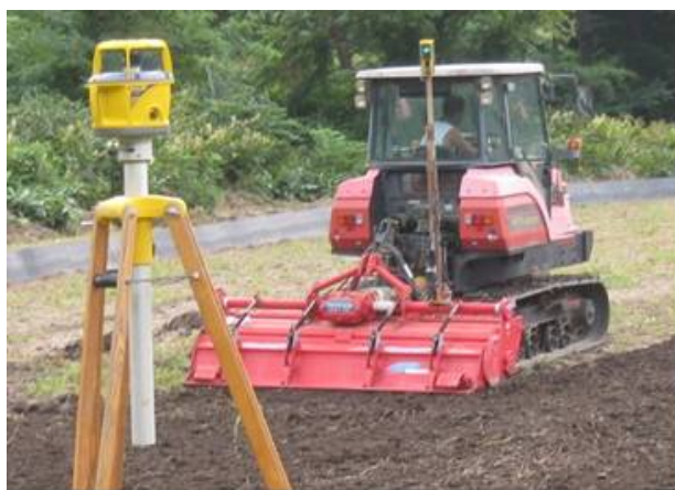
図 I -3.8 レーザーにより耕深を管理した碎土
