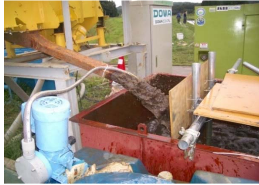
図 II -2.5 原泥水の流送と混合槽での凝集剤添加
