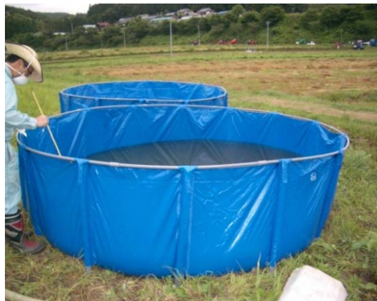
図Ⅱ-3.11 固液分離した排水および脱水袋から浸みだした排水の貯留と濁度の観察
