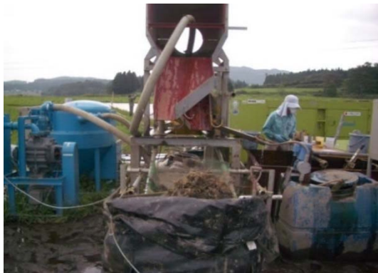
図 II -2.5 原泥水の流送と混合槽での凝集剤添加
