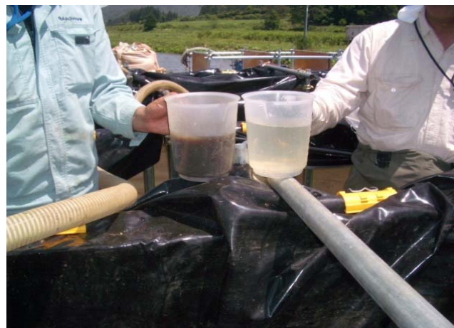
図 II-3.8 凝集・沈殿後の固液分離状況(左:泥水、右:上澄み水)
