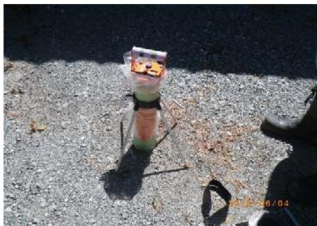
図4 土壤濃度測定器による直接測定
