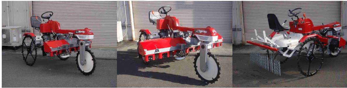
4条用高能率水田用除草装置 6条用高能率水田用除草装置 チェーン除草機
