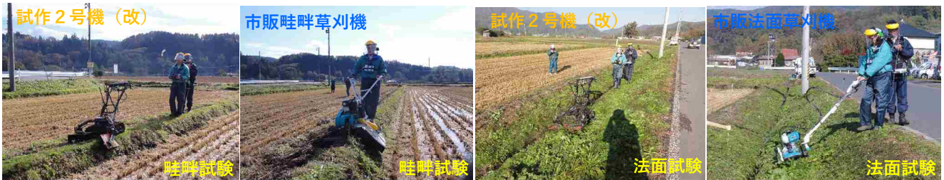
図2 高機動畦畔草刈機試作2号機(改)による現地試験の様子(岩手県二戸市)
