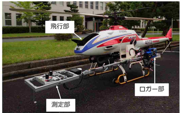
図1 無人ヘリ観測システムの主要諸元および外観
