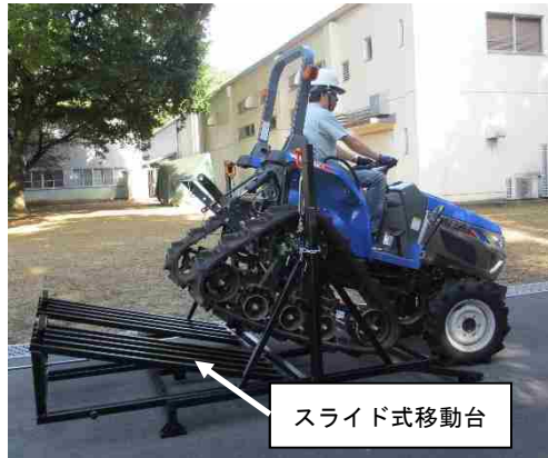
図3 試作した除泥装置（空転式）
