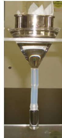
図1 ベールマンロー ートによるセンチュウ分離
