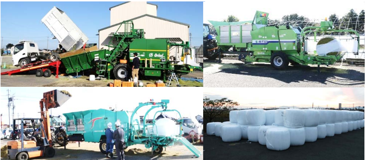
写真3-5 種々の細断型ロールベアラ
