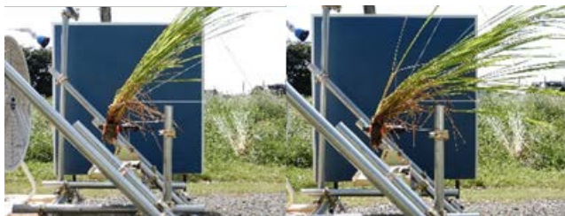
図2-20 人工台風発生機で2分間風水を当たった後の「たちすずか」の様子
