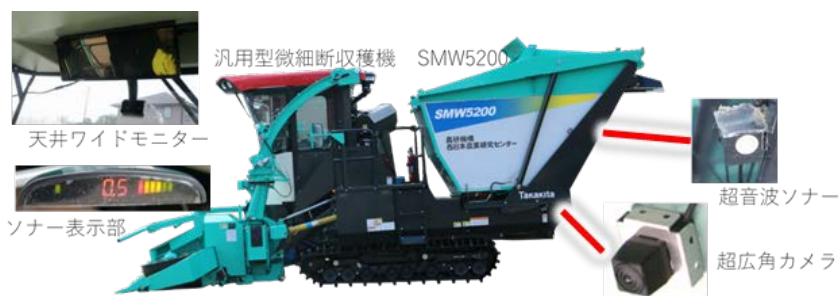
写真3-8 超広角カメラと天井ワイドモニター、ソナー
