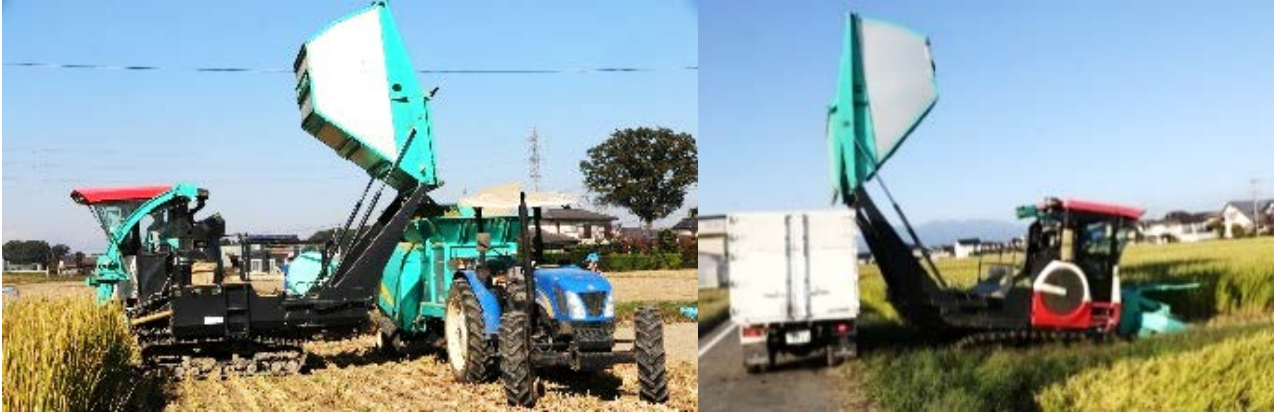
写真3-3 汎用型微細断飼料収穫機（ワゴンタイプ）からの荷移し作業
