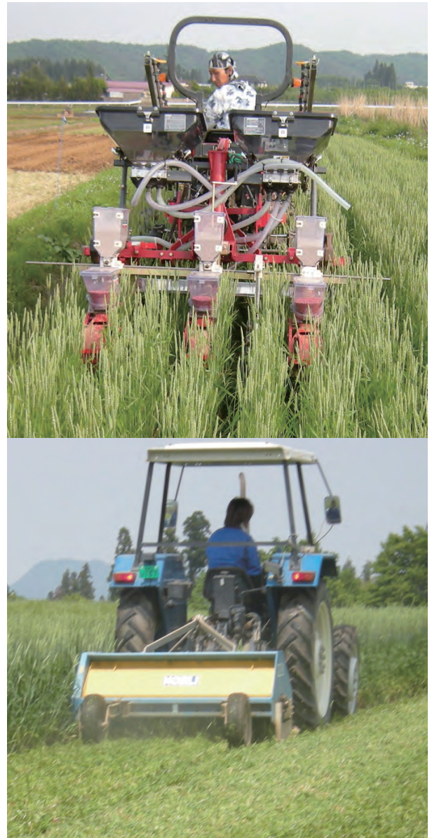
図1 ムギ類カバークロープを利用した不耕起ダイズ栽培。(上) ムギ類立毛中にダイズを不耕起播種。ムギ類は収穫するわけではないので、多少踏んでしまっても支障はない。(下) 播種後、ムギ類地上部の全量を粉砕。作業体系としては、ムギ類を粉砕後にダイズを播種する方法も考えられる。
