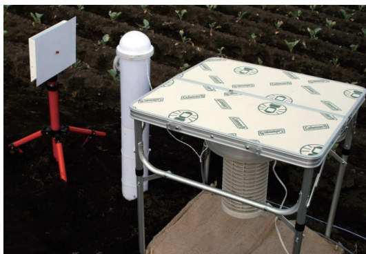
図10 電撃殺虫器(右)による計数とフィールドサーバ(中央)に内蔵されたカメラを用いて粘着板(左)の画像観測を同時に行う害虫計数システム
