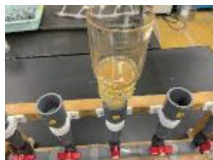
参考 - 図 4-6 フィルター ホルダーでの吸引過
