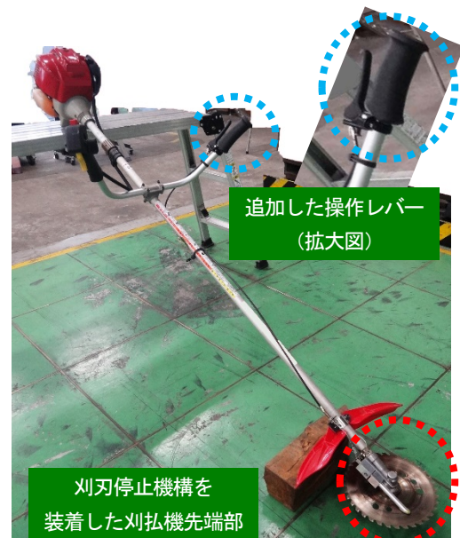
図 2 刈刃停止機構を搭載した試作機
