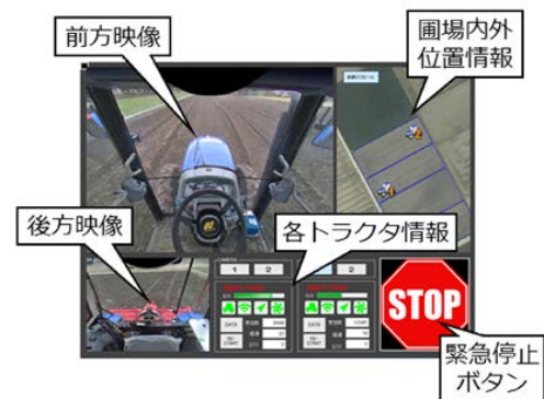
図2 オペレータが持つ遠隔監視記録装置の画面
