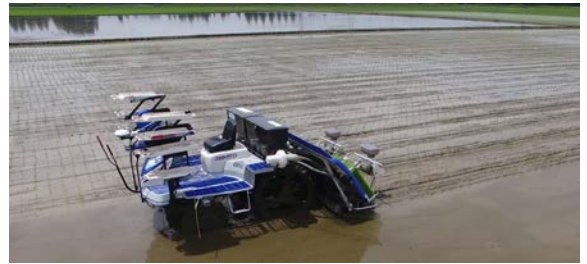
図1 自動運転中の開発機
