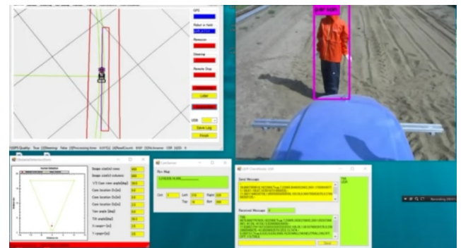
図4 人検知システムを用いた緊急停止 おわりに
