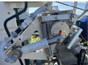
中には、注射器構造のポンプ
