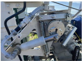
中には、注射器構造のポンプ
