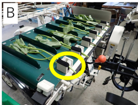
B:苗がセットされた苗供給ブラシ(写真の黄色丸はブラシ式苗挟持部)。
