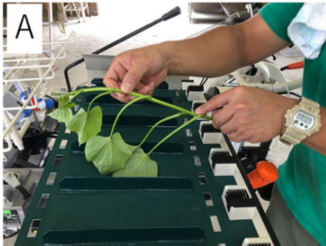
A:苗供給ベルトに苗をセットする様子。
