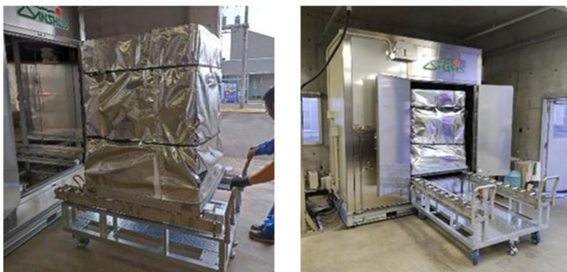
図 2-8 基腐病用蒸熱処理装置（三州産業株式会社製 VT-24K）
