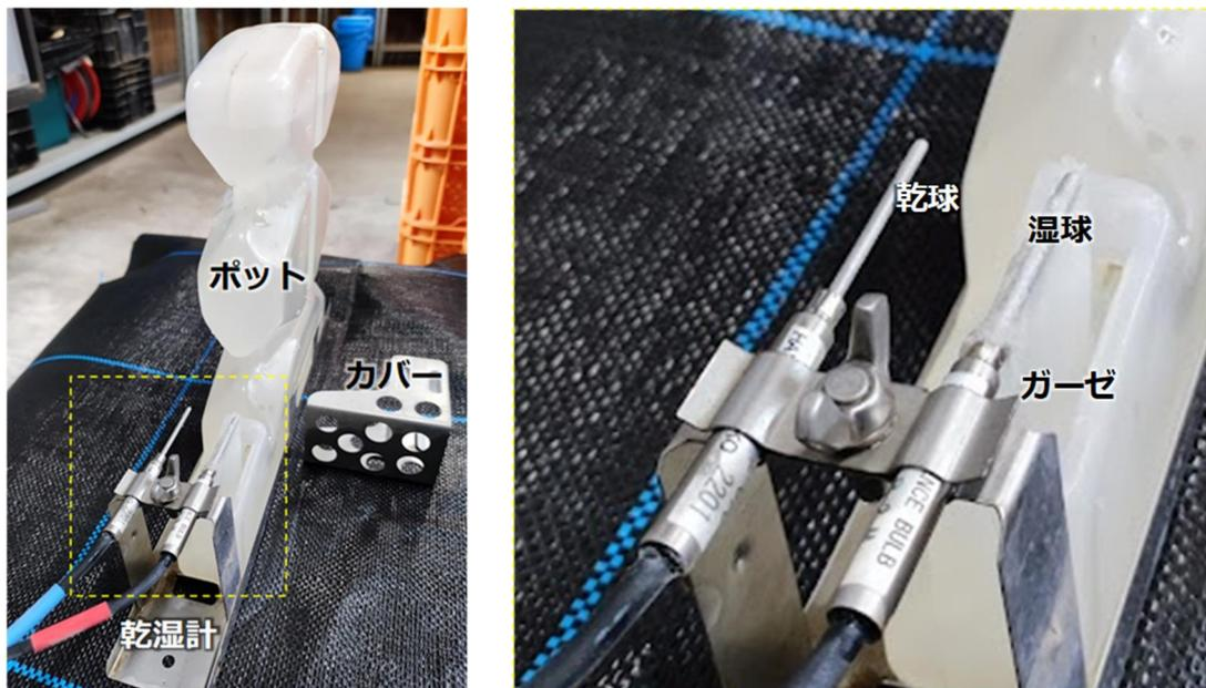
図 2-10 乾湿計（右写真は乾湿球の感温部を拡大）
