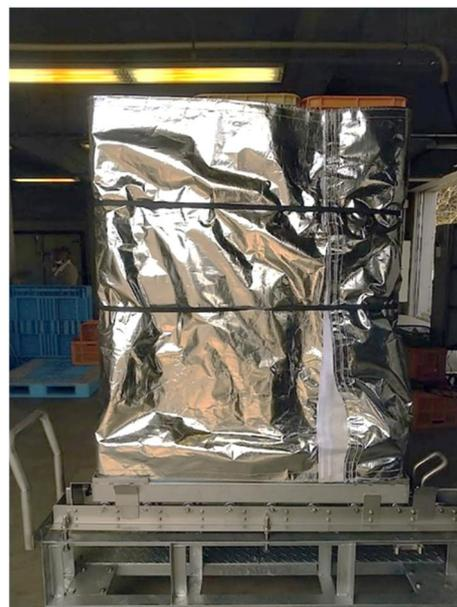
図2-3 コンテナ側面へのカバーシートの装着
