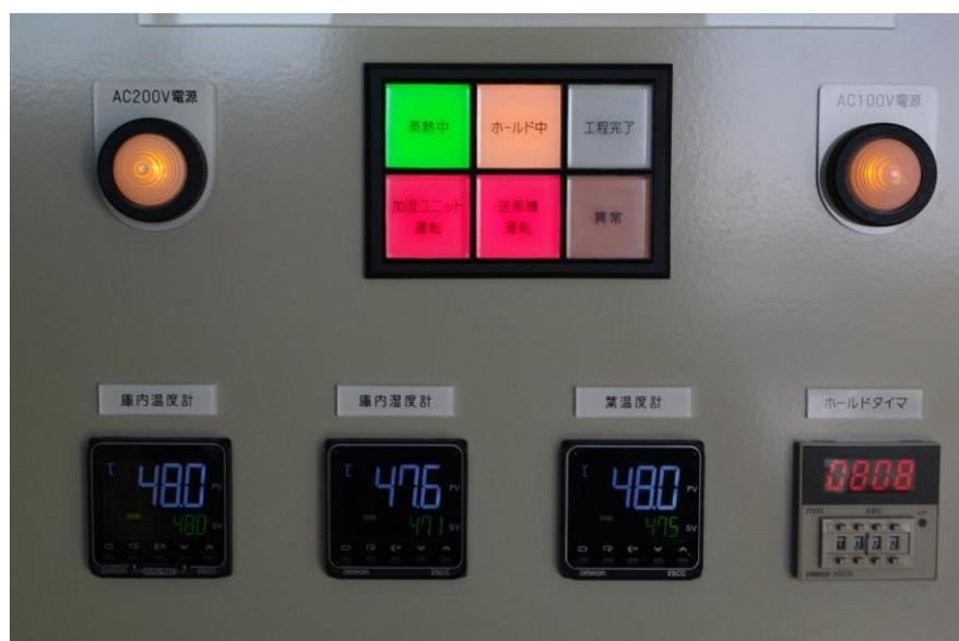
図 III-2-1 蒸熱処理装置制御盤
