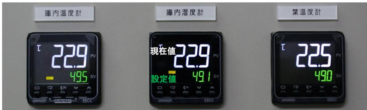
この蒸熱処理装置では湿度は湿球温度の制御で代用しているため、50℃に設定すると 0.5～1℃ほど高めに実測される傾向があります。この設定初期値で処理を開始し、10 分間のホールド中に 51℃以上にならないことを確認してください。葉温度計は庫内温度計より常に低めに設定してください。同じ設定値にするとホールドタイマーが作動しない原因になります。
