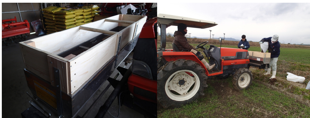
図 2-13 ライムソワーの容量を 60kg から 80kg に増量しほ場の端で補充可能に
