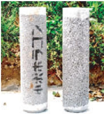
写真1 透水性コンクリートパイプ
