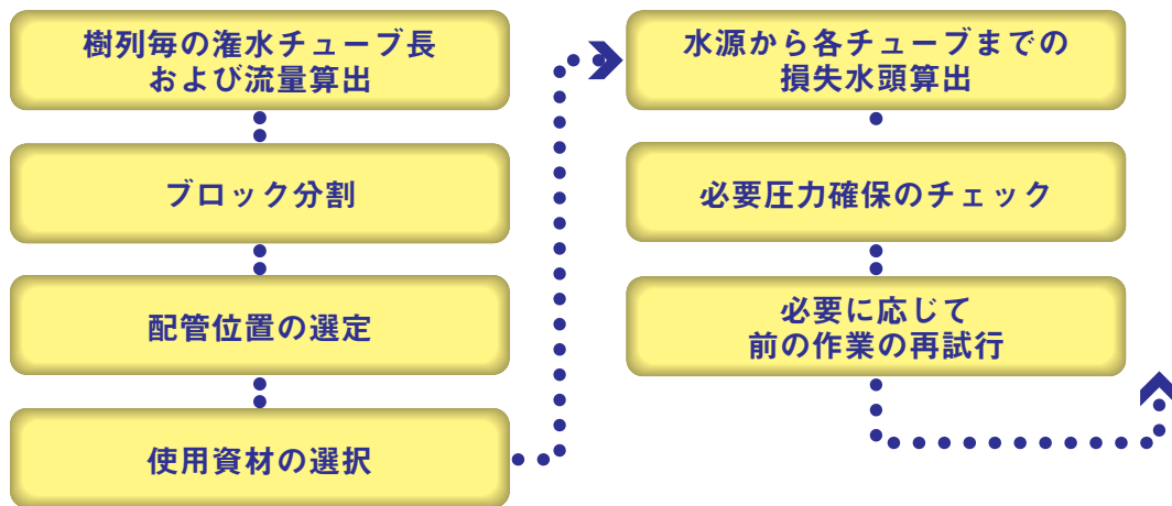
図23 システムの水理設計フロー
