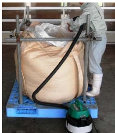
写真4 大型掃除機で 内袋から空気を吸引
