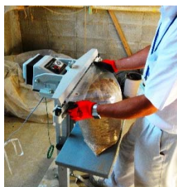
写真7 破碎直後にPE袋に封入 (ボタン型ガス抜きバルブ付)
