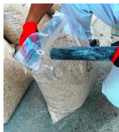
写真8(左)、9(右) 密封後にバルブ上から掃除機で脱気
