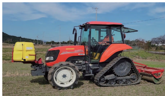
▲トラクター牽引型ローラでの麦踏み作業
