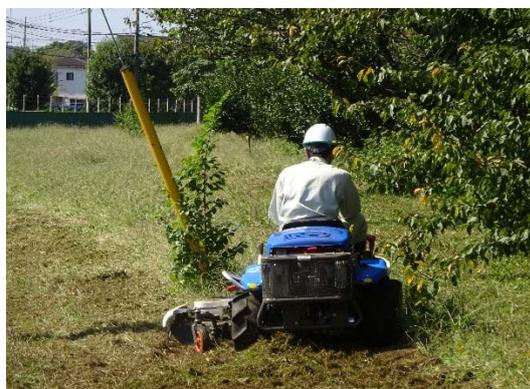
図3 小型乗用刈払機による作業
