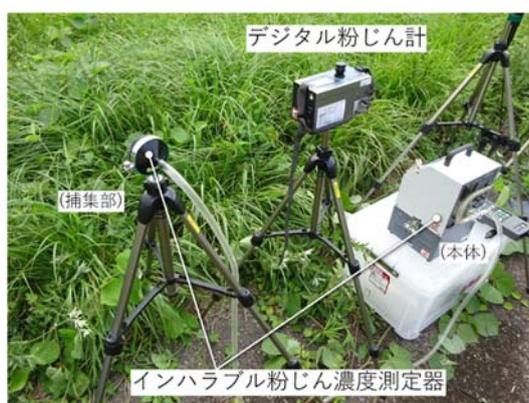
図8 2種類の粉じん計による計測の様子
