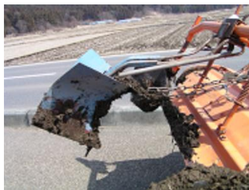
第1-2図 畝立て耕起（上）と作業時にトラクターに装着する培土板（下）
