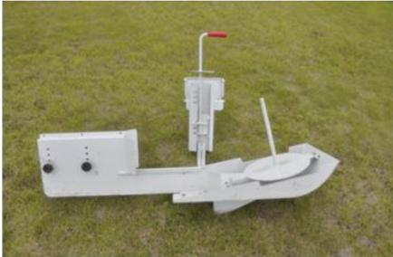
〔使用方法〕乗用田植機の側面に装着し、ロール状の畦畔板を装着してほ場内を走行すると自動的に設置されます。
