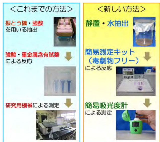
図2 現状の土壌診断法(リン酸)と 新たな現場型評価法の概要・特徴
