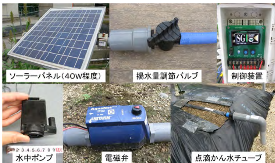
図4 低コスト養液土耕装置（拍動型）に必要な資材の具体例
