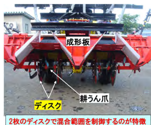
図2 うね内部分施用機の部分施用部
