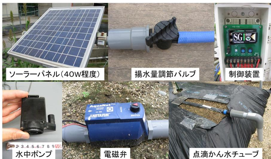
図4 低コスト養液土耕装置（拍動型）に必要な資材の具体例
