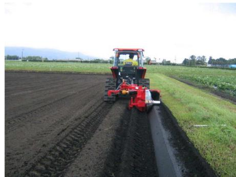
写真3 畦塗機による畦塗り作業
