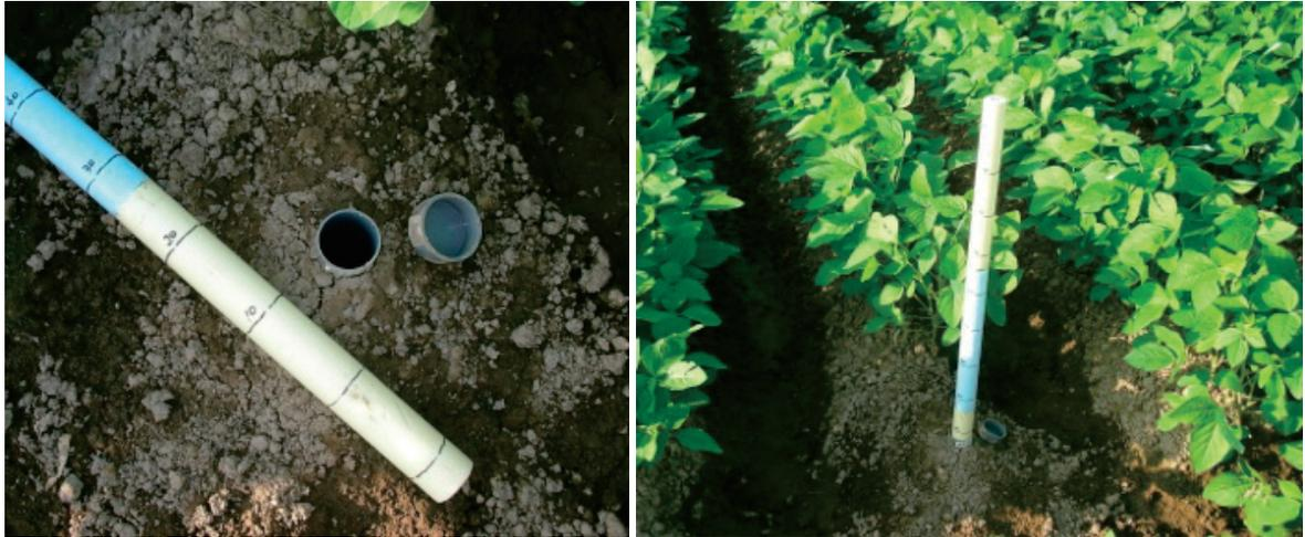
図3 発泡スチロールを用いた地下水位観測の様子
