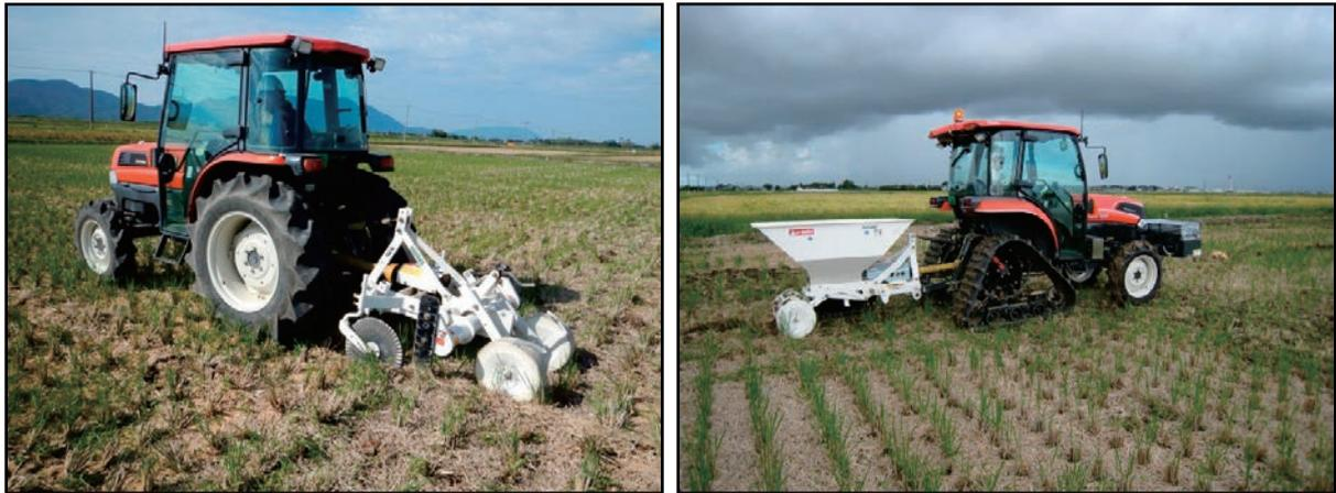
図5 機能回復技術としての弾丸暗渠の施工状況
