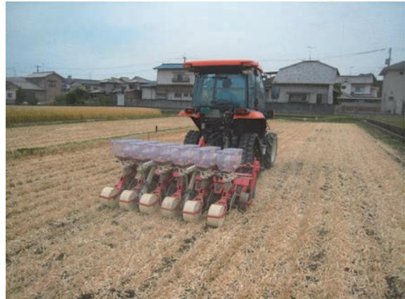
図1 裸麦収穫後、不耕起圃場における乾田直播の様子。近中四農研試験圃場、2015年5月28日播種
