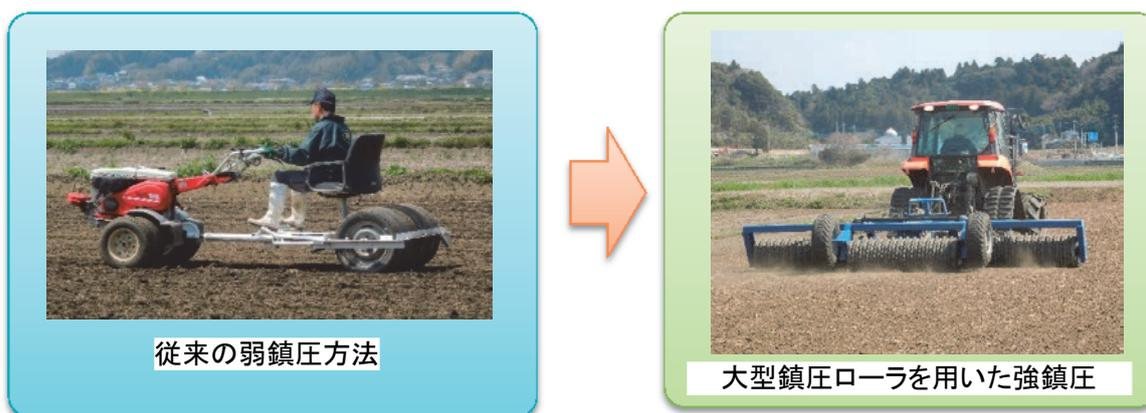
図2 鎮圧作業の改善方法(千葉県横芝光町現地圃場、灰色低地土)
