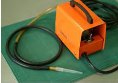
図1 吸虫管および吸引ポンプ
