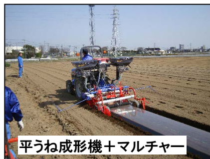
平うねマルチ用うね内部分施用機 (ブロッコリー・レタス等)
