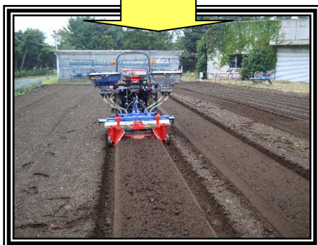
平うね用うね内部分施用機 (ブロッコリー等)
