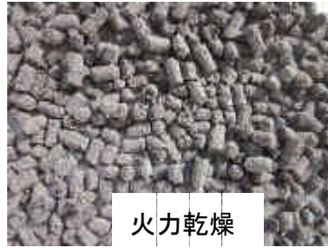
図4 火力乾燥によって製造したペレット
