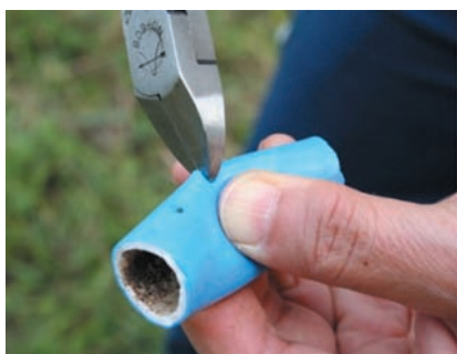
図2 弾性ボールの準備 水道用ホースにニッパーで切れ込みを付けて弾性ボールに差し通す
