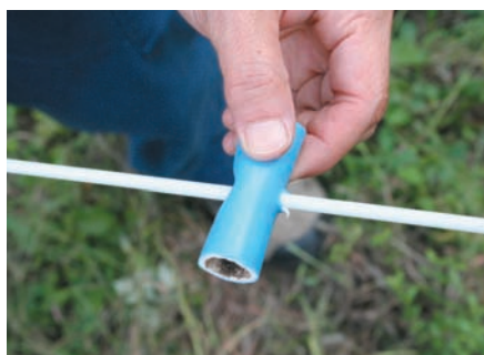
図2 弾性ボールの準備 水道用ホースにニッパーで切れ込みを付けて弾性ボールに差し通す
