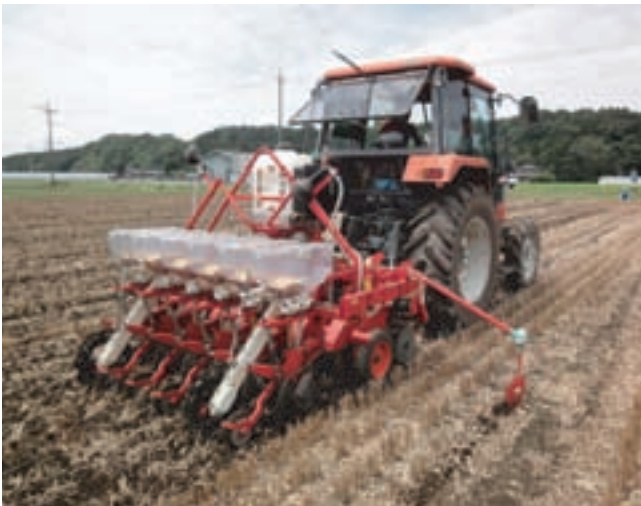
図1 ディスク作溝型不耕起播種機による大豆の播種作業
