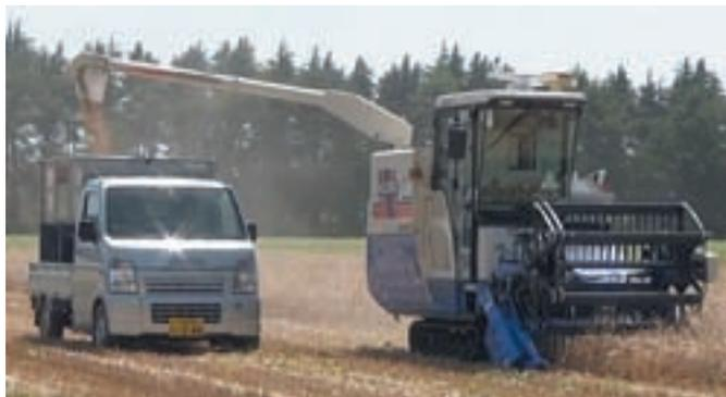
写真 小麦の自動収穫を行うコンバインロボットとタンク満杯時に荷受け・伴走する軽トラック
