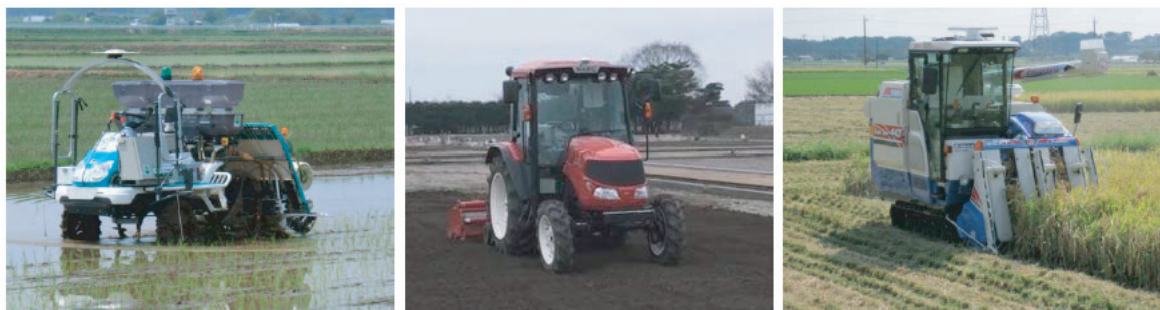
図3 中央農研で開発した農作業ロボット (左から順に、田植えロボット、トラクタロボット、コンバインロボット、いずれも作業中の様子)
