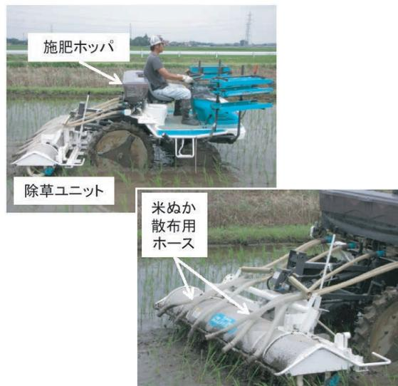
多目的田植機に接続した除草ユニットによる機械除草同時米ぬか散布作業(上)と除草ユニットの拡大写真(下)
